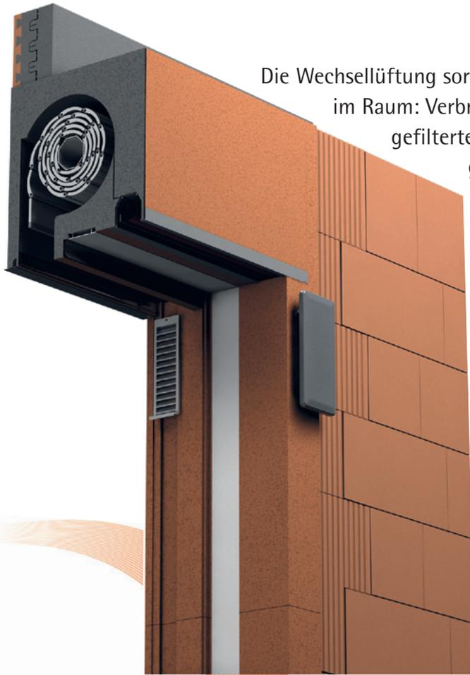
Die Wechsellüftung sorgt für ein anhaltendes, angenehmes Klima im Raum: Verbrauchte Luft wird nach draußen abgeleitet und gefilterte, gereinigte Luft von dort wieder zugeführt – ganz ohne Pollen und Schadstoffe. Dabei ist AIRFOX® nicht nur extrem leise, durch die integrierte Wärmerückgewinnung werden auch Wärmeverluste verhindert, die bei Fensterlüftung entstehen. Ebenso wird Schimmelbildung aufgrund von Lüftungsdefiziten vermieden. So ist eine perfekte Wohnatmosphäre garantiert –
