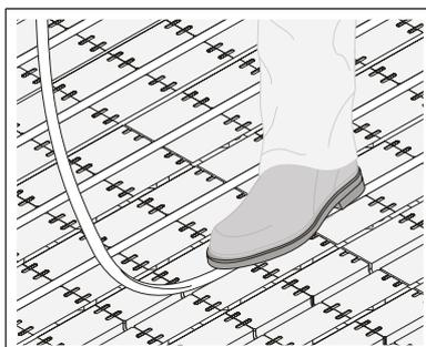
8. Das Heizrohr der Dimension 14 mm am Vorlaufverteiler befestigen und entsprechend des Verlegeplanes verlegen. Befestigen Sie das Rohr am Rücklaufverteiler. Die Rohrbögen müssen im Verteiler bleiben! Möglichst enger Biegeradius. Evtl. eine Biegefeder einsetzen.
