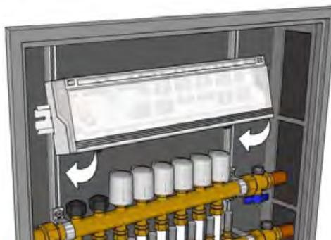
Basis leicht gekippt auf die Hutschiene aufsetzen und einrasten lassen.
